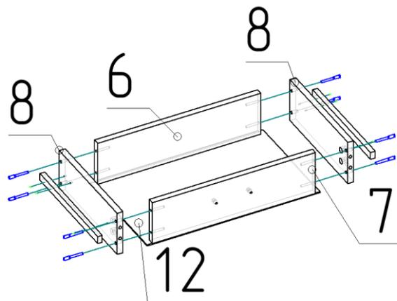
3) Детали ящика (6, 7, 8) собираем на евровинт 6,3\*50. После чего саморезами 3,5\*16 прикрепите к боковинам ящика другую часть направляющей. Дно ящика ДВП (12) прибиваем гвоздями 1\*20.
