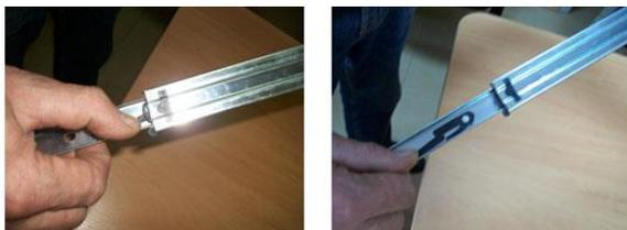
При помощи тех же фиксаторов ящик вытягивается из готового изделия. При этом фиксатор с одной стороны нажимается вниз, а с другой вверх. Саморезами 3,5\*16 к боковинам (2) и (1) крепим широкие части направляющих. Закрепите боковины к дну тумбы при помощи евровинтов 6,3\*50. После чего эксцентриковой стяжкой крепим крышу (3).
